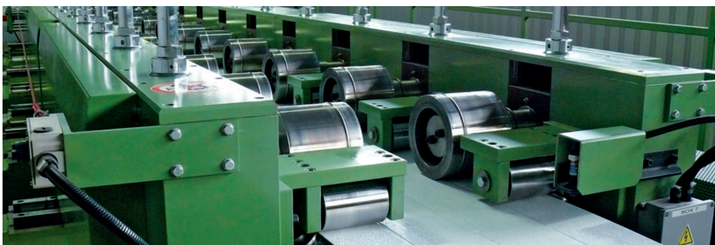
Segmentų gamybos pradžia – skardos formavimas
